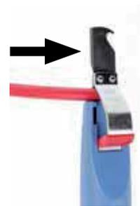
5. Ziehen Sie das Werkzeug ans Schlauchende, um die Ummantlung längs zu schlitzen.
