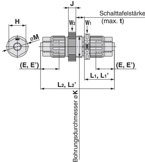
(E,E'): Referenzabmessungen für den eingesteckten Schlauch ab Endfläche der Mutter
