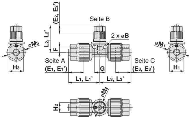
(E1, E1', E2, E2', E3, E3'): Referenzabmessungen für den eingesteckten Schlauch ab Endfläche der Mutter
