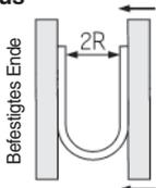
Den Schlauch bei einer Temperatur von 20 °C in U-Form biegen. Ein Ende befestigen und das andere langsam heranbiegen. Die Distanz 2R an der Stelle messen, an der die Änderungsrate des Außendurchmessers 5 % beträgt.
