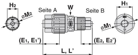
(E1, E1', E2, E2'): Referenzabmessungen für den eingesteckten Schlauch ab Endfläche der Mutter
