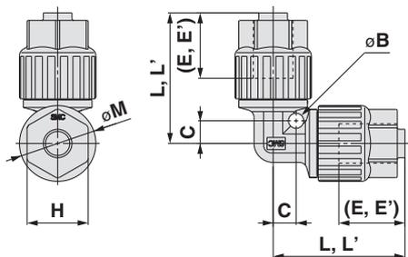
(E,E'): Referenzabmessungen für den eingesteckten Schlauch ab Endfläche der Mutter
