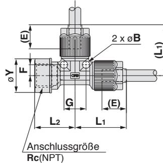
(E) Zirka-Einstecktiefe des Schlauches in der Verschraubung
