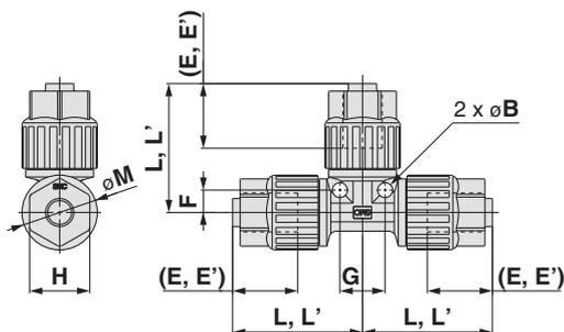
(E,E'): Referenzabmessungen für den eingesteckten Schlauch ab Endfläche der Mutter
