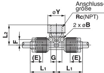
(E) Zirka-Einstecktiefe des Schlauches in der Verschraubung
