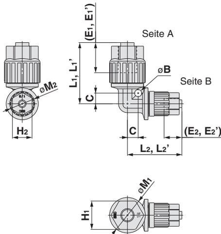
(E1, E1', E2, E2'): Referenzabmessungen für den eingesteckten Schlauch ab Endfläche der Mutter
