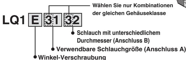
**Winkel-Steckverbindung (LQ1E)/Steckverschraubung (LQ1U) Bestellschlüssel**
