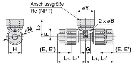
(E, E'): Referenzabmessungen für den eingesteckten Schlauch ab Endfläche der Mutter
