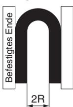
Biegen Sie den Schlauch bei einer Temperatur von 20 °C in eine U-Form. Befestigen Sie ein Ende und biegen Sie das andere langsam ein. Messen Sie 2R, wenn sich der Schlauchdurchmesser an der Biegung um 5 % verformt.
