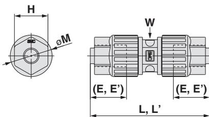
(E,E'): Referenzabmessungen für den eingesteckten Schlauch ab Endfläche der Mutter
