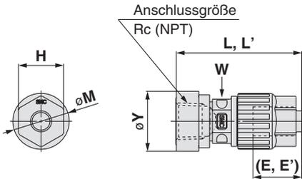
(E, E'): Referenzabmessungen für den eingesteckten Schlauch ab Endfläche der Mutter
