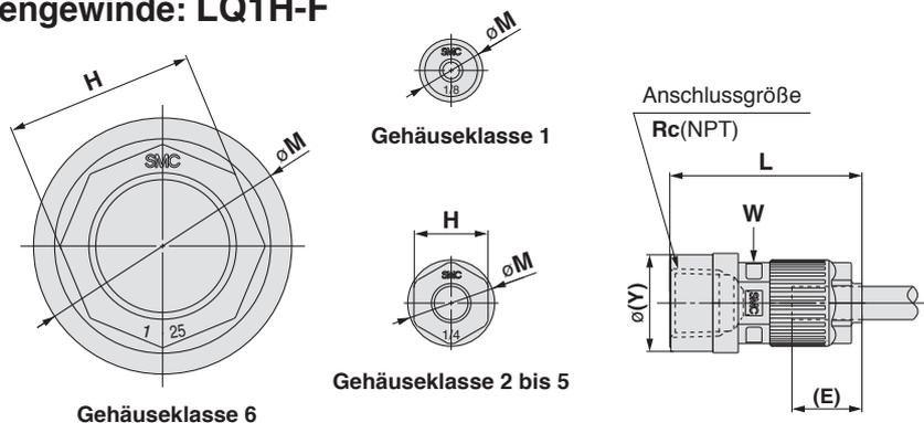
(E) Zirka-Einstecktiefe des Schlauches in der Verschraubung
