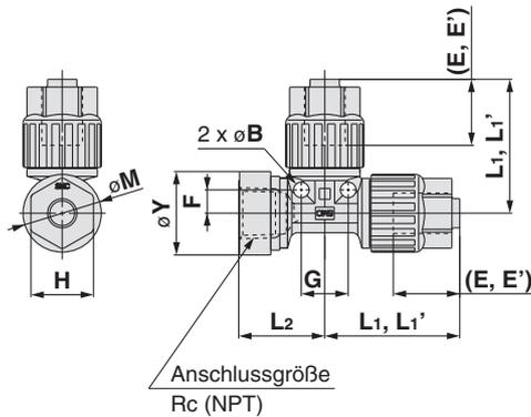
(E, E'): Referenzabmessungen für den eingesteckten Schlauch ab Endfläche der Mutter
