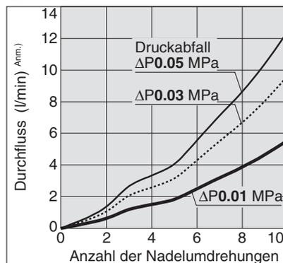
Anm.) Da die Serie LVN nicht als Absperrventil eingesetzt werden kann, ist es nicht möglich, den Durchfluss auf Null zu setzen, wenn die Drossel vollständig geschlossen ist. Siehe „Vorsichtsmaßnahmen zum Betrieb“ für weitere Angaben.
