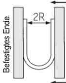
Den Schlauch bei einer Temperatur von 20 °C in U-Form biegen. Ein Ende befestigen und das andere langsam heranbiegen. Die Distanz 2R an der Stelle messen, an der die Änderungsrate des Außendurchmessers 5 % beträgt.
