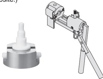
2. Ziehen Sie die Mutter fest, bis sie den Anschlag des Gehäuses berührt, führen Sie anschließend eine weitere 1/8-Drehung durch. Falls die Mutter nicht weiter festgezogen werden kann, bedeutet dies, dass sie schon ausreichend festgezogen ist. Beachten Sie dazu die nachstehend angegebenen Anzugsmomente.
