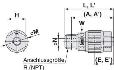
(A,A'): Referenzabmessungen nach Einbau
