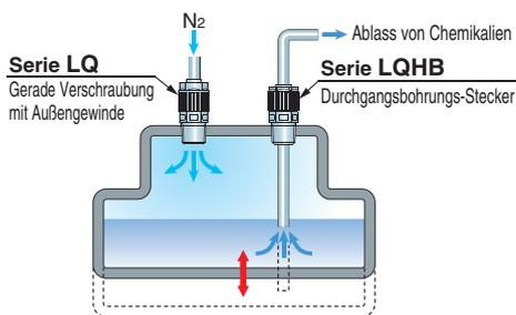
Eine Änderung der Schlauchposition ist je nach Behältertiefe möglich.
