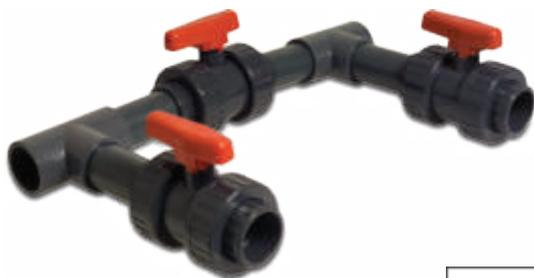
By-pass-Kit für Schwimmbad Wärmepumpen mit dem Sie die Wasserzufuhr zu Ihrer Wärmepumpe steuern. Optimale Wärmepumpeneinstellung erfolgt durch Drosselung des Kugelhahnes am Wasserauslauf.
