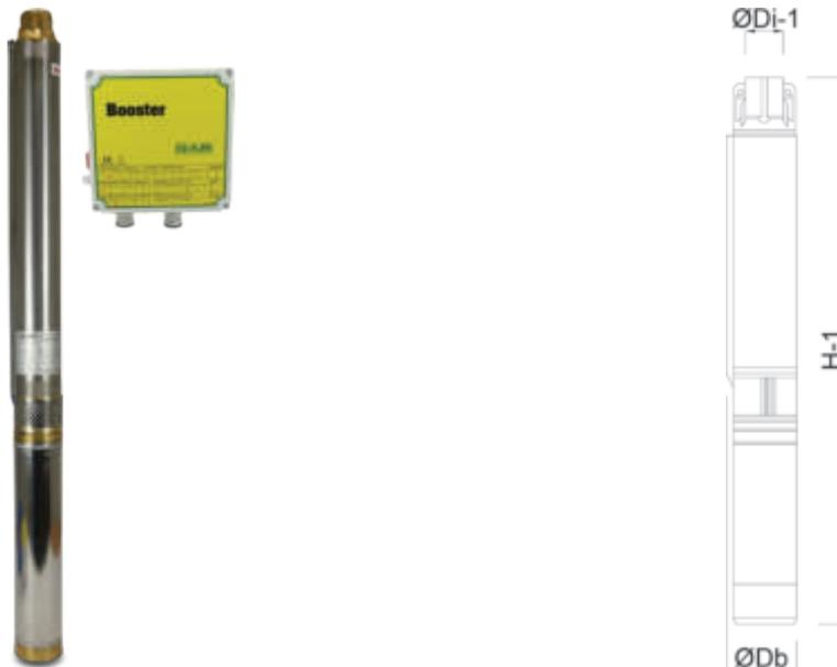
Inklusive montiertem 15 m Kabel und Steuerbox-Booster. Förderflüssigkeit: sauber, frei von Feststoffen und Schleifmitteln, nicht viskos, nicht aggressiv und chemisch neutral, mit wasserähnlichen Eigenschaften. Maximal zulässige Menge an Sand: 40 g/m<sup>3</sup>. Installation: in 3-Zoll-Brunnen oder größer, Tanks und Zisternen, vertikale Lage. Bei waagerechter Installation ist auf eine minimale Belastung der Druckbaugruppe zu achten.
