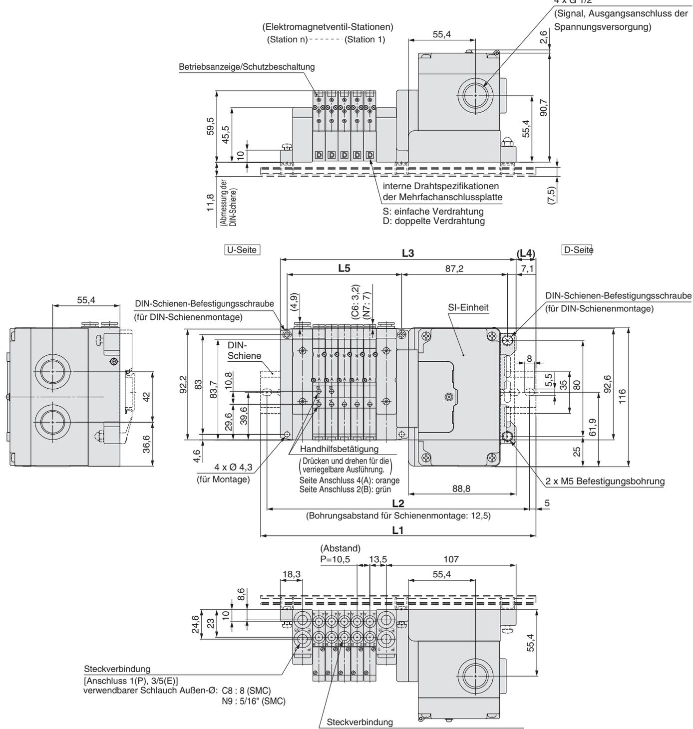
Anm.) Den spritzwassergeschützten Verschlussstopfen (AXT100-B04A) für das nicht verwendete Signal und den Ausgangsanschluss der Spannungsversorgung verwenden (G 1/2).
