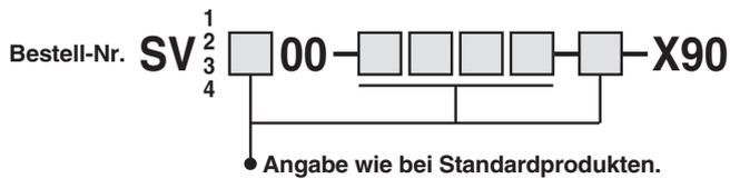
Anm.) Da in der Serie-X90 Fluor-Kautschuk für das Hauptventil verwendet wird, ist der Einsatz für Anwendungen, die Hitzebeständigkeit erfordern, zu vermeiden.
