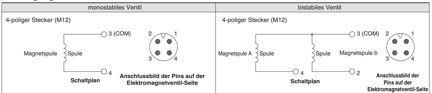
Anm.) Elektromagnetventile haben keine Polarität.
