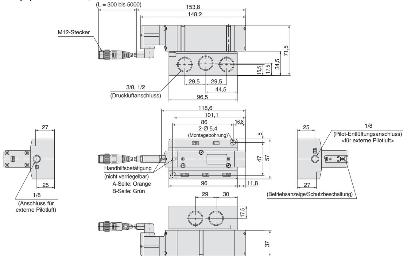
5/3-Wege Mittelstellung geschlossen/Mittelstellung offen/Mittelstellung druckbeaufschlagt [M12-Stecker IP67]
