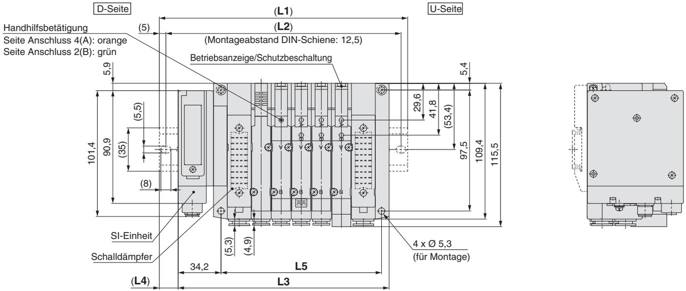
Anm. 1) Die Positionen des Anschlusses für externe Vorsteuerung und des Schalldämpfer-Entlüftungsanschlusses sind dieselben wie die P-, E-Ausgangsanschlusspositionen.
