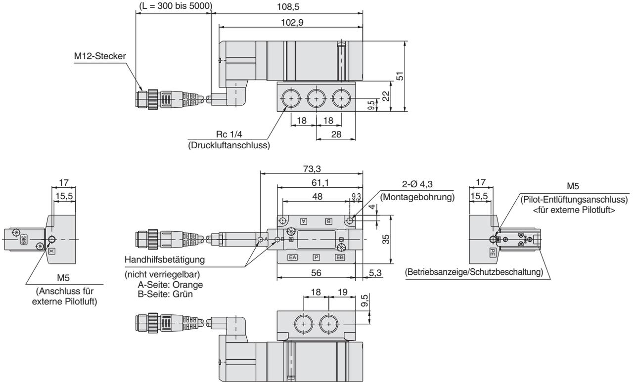
**5/3-Wege Mittelstellung geschlossen/Mittelstellung offen/Mittelstellung druckbeaufschlagt [M12-Stecker IP67]
