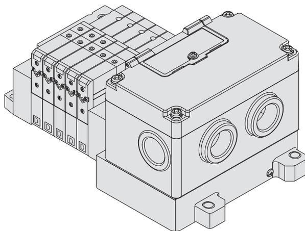
Verfügbare Serien **Mehrfachanschlussplatte Zugankertyp
