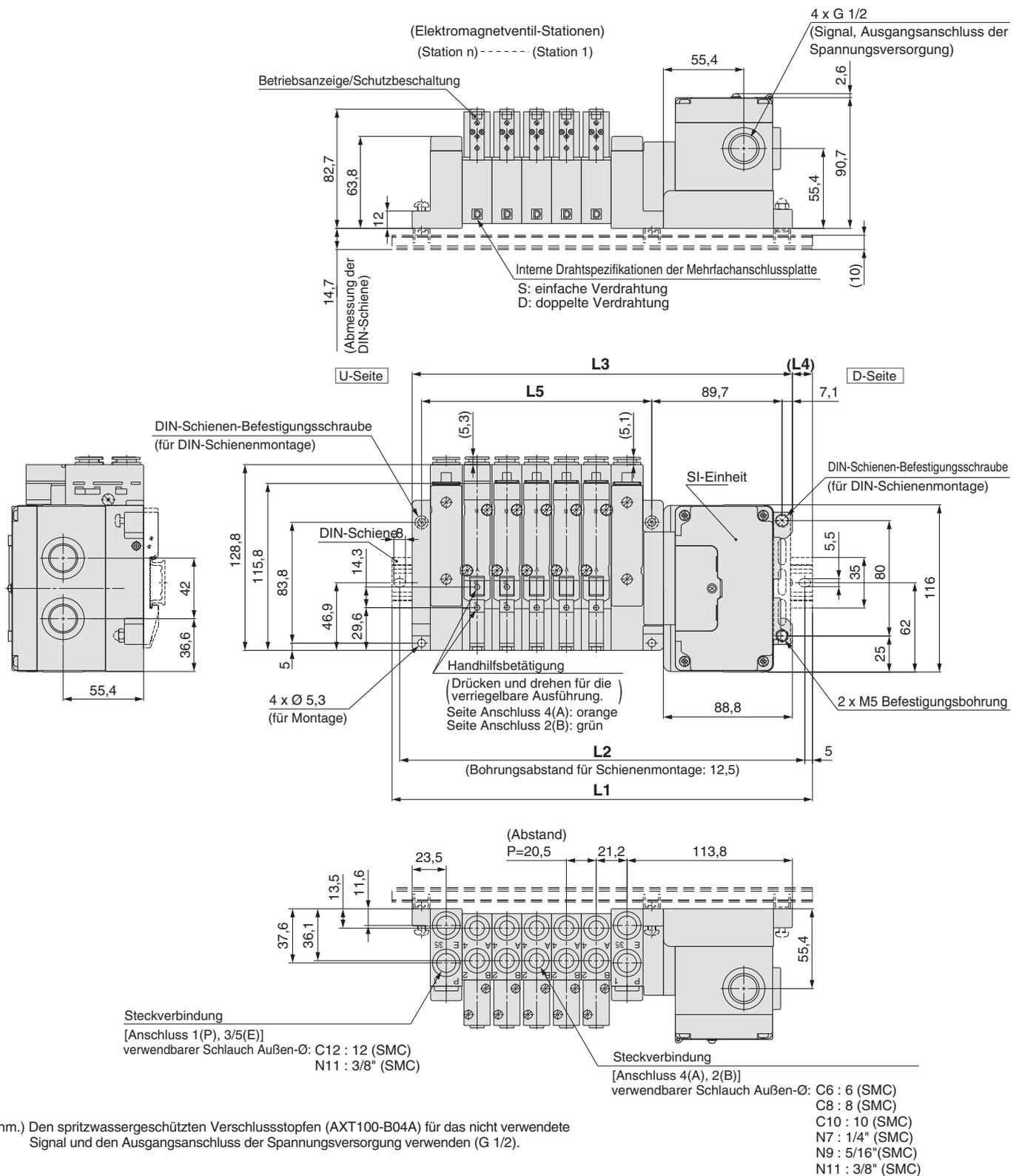
Anm.) Den spritzwassergeschützten Verschlussstopfen (AXT100-B04A) für das nicht verwendete Signal und den Ausgangsanschluss der Spannungsversorgung verwenden (G 1/2).
