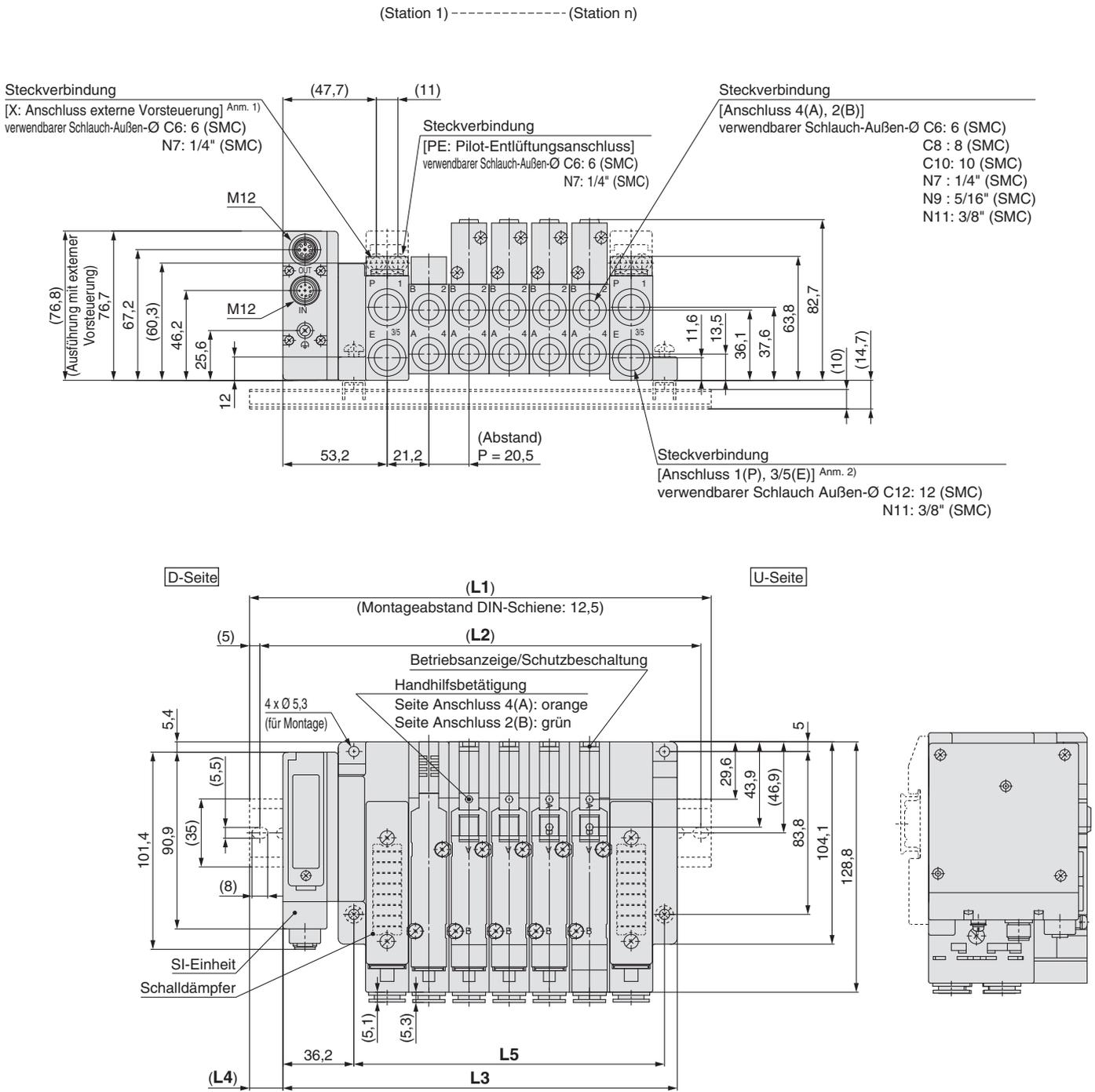
Anm. 1) Die Positionen des Anschlusses für externe Vorsteuerung und des Schalldämpfer-Entlüftungsanschlusses sind dieselben wie die P-, E-Ausgangsanschlusspositionen.
