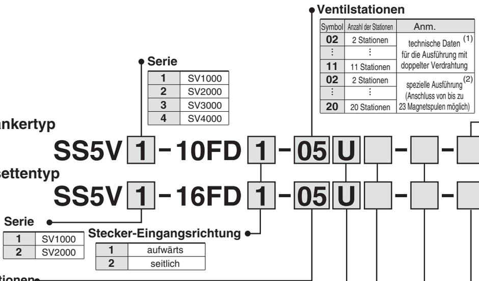
Anm. 1) Für doppelte Verdrahtung: Monostabile, bistabile und 2x 3/2- und 5/3-Wege-Elektromagnetventile können an allen Stationen der Mehrfachanschlussplatte verwendet werden. Der Einsatz eines monostabilen Magnetventils hat ein ungenutztes Kontrollsignal zur Folge. Bestellen Sie eine spezielle Ausführung, wenn Sie dies vermeiden wollen.
