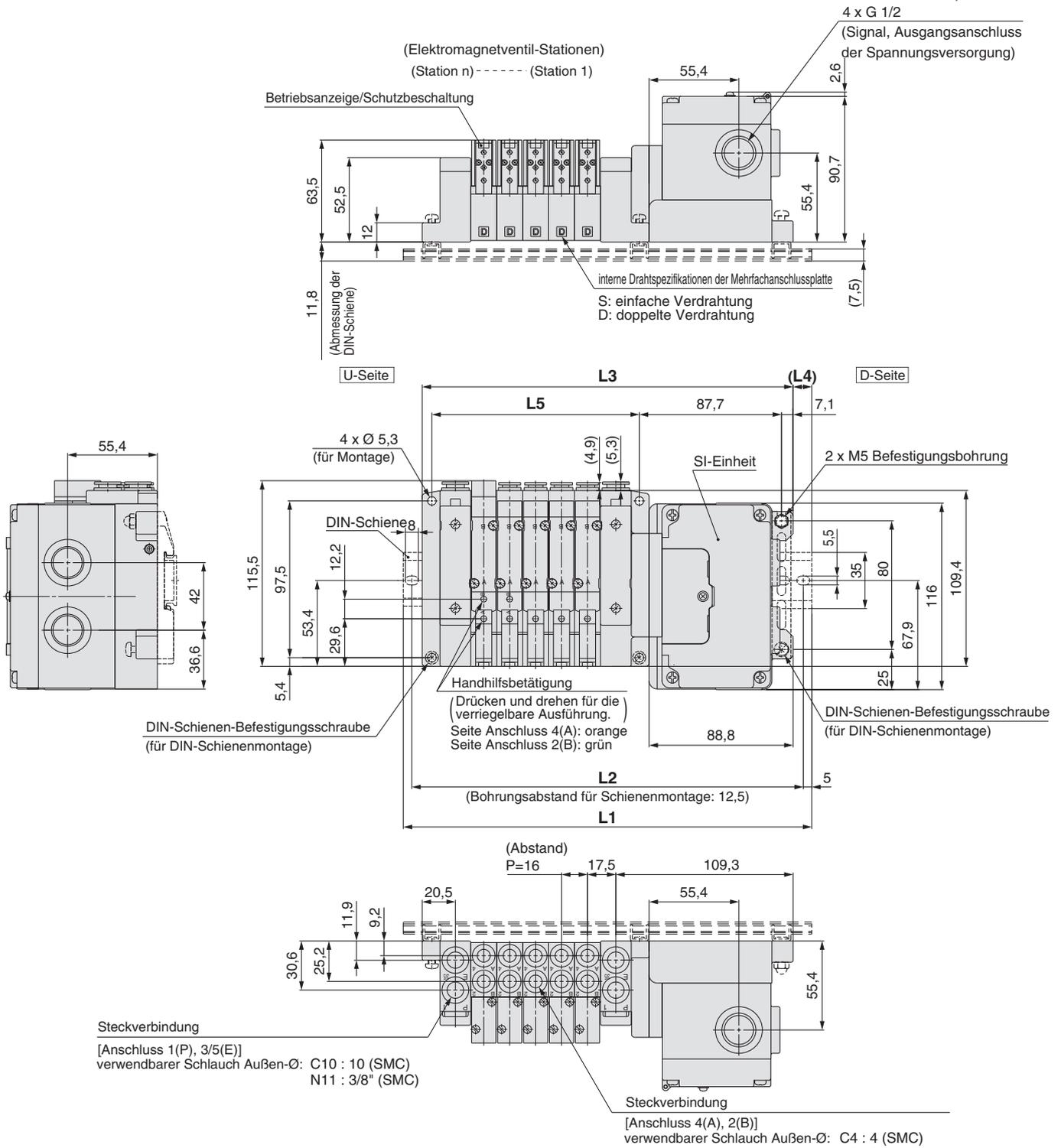
Anm.) Den spritzwassergeschützten Verschlussstopfen (AXT100-B04A) für das nicht verwendete Signal und den Ausgangsanschluss der Spannungsversorgung verwenden (G 1/2).
